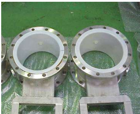
(photo 2)经过6个月后的储罐内侧 左：DAIKIN NEW PTFE SHEET 右：普通PTFE GBK
